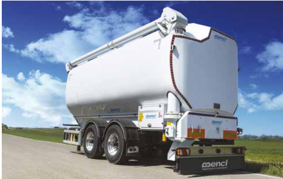
Semirreboque com cisterna autoportante
