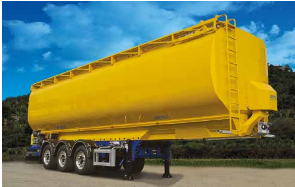
Semirreboque com cisterna autoportante
