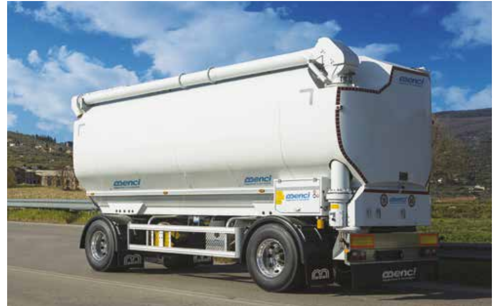
Semirreboque com cisterna sobre o quadro
