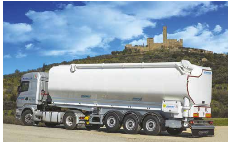
Semirreboque com cisterna sobre o quadro
